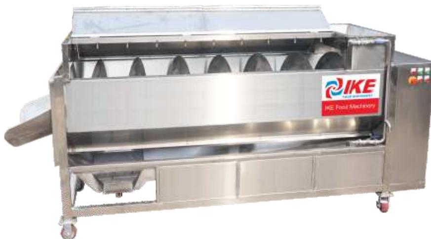
Esta máquina peladora de rodillo de cepillo a gran escala se puede conectar con una máquina elevadora o una máquina cortadora para que el procesamiento de raíces de hortalizas funcione automáticamente. Tiene un tornillo transportador especial para ayudar a que las verduras avancen continuamente. El rociador fijo de agua a alta presión puede funcionar junto con el rodillo para hacer que las verduras estén mucho más limpias.
