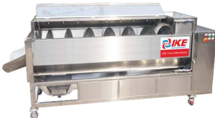
Esta máquina de gran escala para pelar con rodillos cepilladores puede conectarse con una máquina elevadora o una máquina rebanadora para obtener un flujo de trabajo automático en el procesamiento de verduras de raíz. Cuenta con un tornillo transportador especial para ayudar a que las verduras avancen de manera continua. El rociado de agua a alta presión fijo puede trabajar junto con los rodillos para que las verduras queden mucho más limpias.
